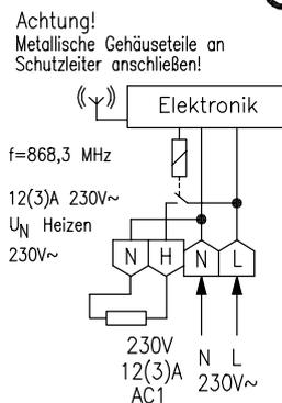
Ansicht von der Rückseite in eingebautem Zustand.
